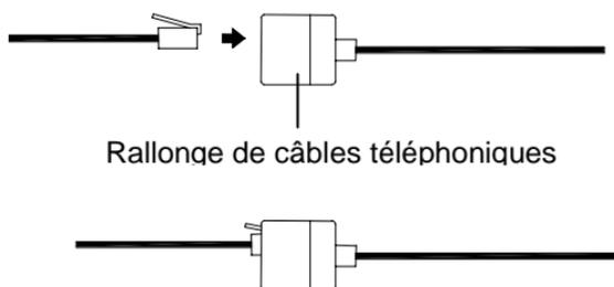
Lorsque l'on installe des rallonges, il convient de s'assurer que les connexions se font encore parfaitement. Et que les câbles choisis ainsi que la longueur installée ne créent pas d'interférences. Une trop grande longueur de câble peut par ailleurs distordre les
