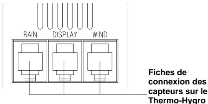
**Important :** Le courant de l'Anémomètre et du Pluviomètre est fourni par le Thermo-Hygro. Les connexions doivent donc être bien assurées entre les capteurs.
