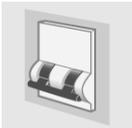
Si l'appareil est branché au secteur par un branchement fixe, il faut prévoir sur la ligne d'alimentation un dispositif d'interruption omnipolaire avec distance d'ouverture des contacts égale ou supérieure à **3 mm** placé de façon à être atteint facilement et proche de l'appareil.
