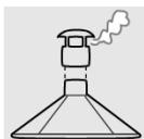
L'évacuation des produits de la combustion doit être assurée au moyen de hotte reliée à une cheminée à tirage naturel de fonctionnement sûr ou bien par aspiration forcée. Un système d'aspiration efficace nécessite une conception soignée par un spécialiste, en respectant les positions et les distances indiquées par les normes. À la fin de l'installation, l'installateur devra délivrer un certificat de conformité.
