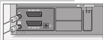
**1** Branchez le câble de l'antenne extérieure dans la prise d'antenne »
