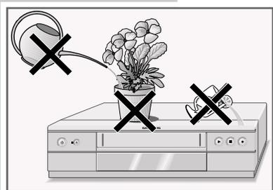
Ne posez pas de récipients contenant des liquides (vases ou autres) sur le magnétoSCOPE. Le récipient peut se renverser et le liquide peut affecter la sécurité électrique.
