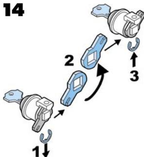
Retirer le crochet de fermeture **1**, le faire pivoter **2** et le remettre en place **3**.
