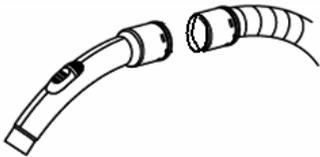
Vissez l'embout du tuyau flexible à l'extrémité de la poignée jusqu'au « clic » de verrouillage.
