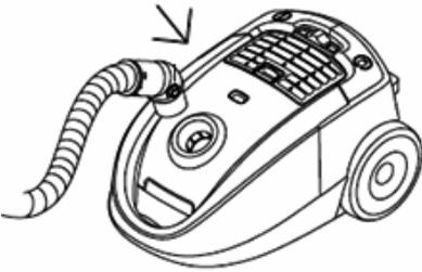
Insérez l'embout du tuyau flexible dans l'orifice de raccordement (12) sur le devant de l'aspirateur. Enfoncez jusqu'à ce que vous entendiez un « clic » et qu'il soit bien verrouillé.
