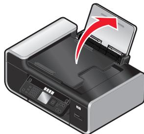
4 Si le panneau de commandes correspondant à votre langue doit être installé, ouvrez l'imprimante et soulevez le panneau de commandes.
