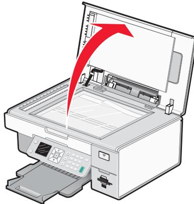
**2** Placez le document original sur la vitre du scanner, face imprimée vers le bas et dans l'angle inférieur droit.
