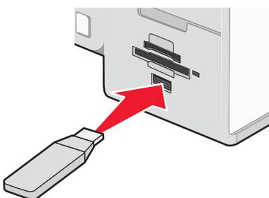
**Remarque :** un adaptateur peut être nécessaire si le lecteur flash ne s'insère pas directement dans le port.
