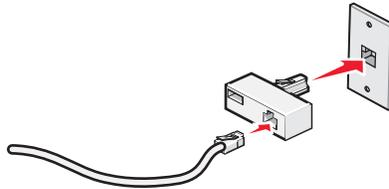
**Remarque** : L'adaptateur représenté est utilisé au Royaume-uni. Celui utilisé dans votre pays peut être différent ; il doit s'adapter au type de prise téléphonique local.
