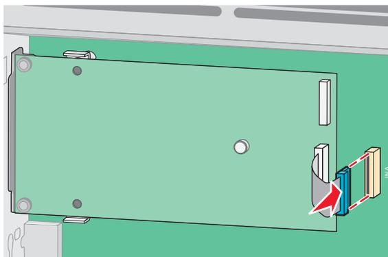
12 Si un disque dur d'imprimante est déjà installé, reliez ce disque dur au port ISP. Pour plus d'informations, reportez-vous à « Installation d'un disque dur sur l'imprimante », page 40.
