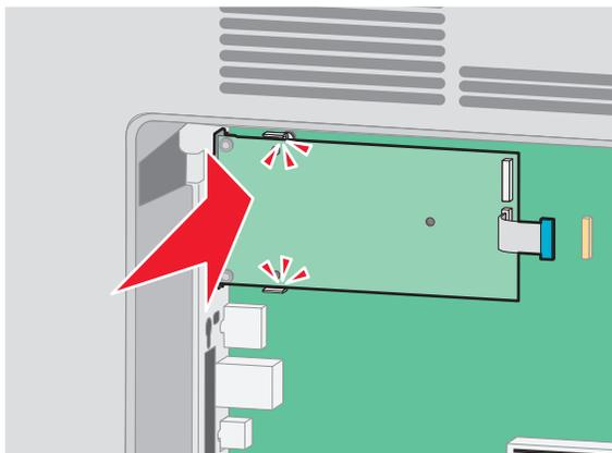
**8** Insérez la longue vis à ailettes, puis vissez-la dans le sens des aiguilles d'une montre afin de fixer le port ISP. Ne la serrez pas complètement.
