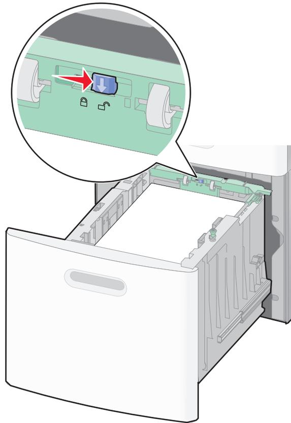
**4** Poussez le loquet d'ouverture du guide de longueur afin de soulever ce dernier, faites-le glisser de façon à l'ajuster au format du support chargé, puis verrouillez-le.
