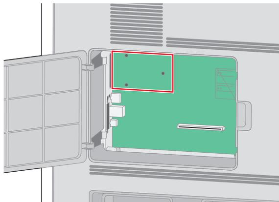
**Remarque :** si un port ISP en option est installé, vous devez installer le disque dur de l'imprimante sur ce port.
