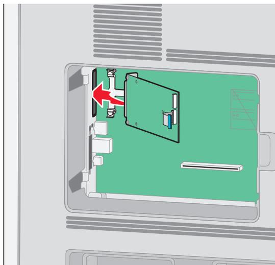
**7** Abaissez le port ISP vers le support en plastique jusqu'à ce que le port soit placé entre les guides du support.
