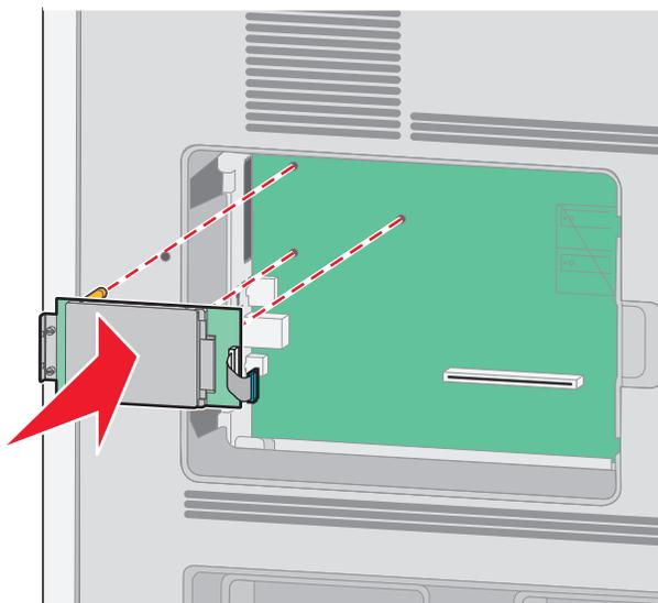
**b** Vissez les deux vis fournies pour fixer le support de montage du disque dur de l'imprimante.
