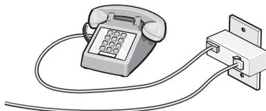
**2** Raccordez votre appareil de télécommunication directement au port EXT situé derrière l'imprimante.
