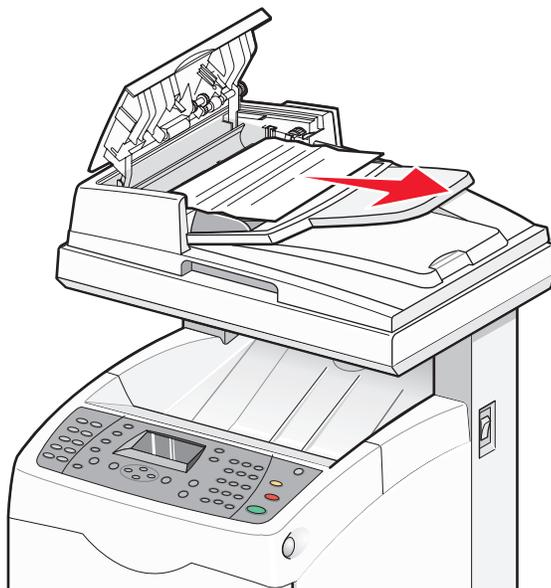
**3** Si le bouchage se situe au niveau de la zone de sortie du papier, tournez le bouton de façon à éliminer le bouchage.
