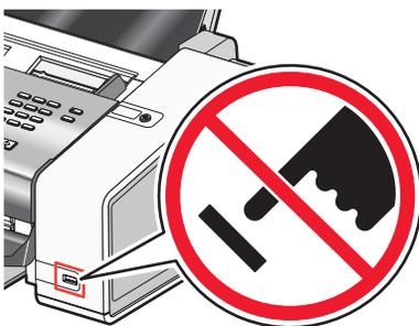
**Avertissement :** ne touchez pas le câble USB, les adaptateurs réseau ou la zone de l'imprimante indiquée lorsque des opérations d'impression sont en cours à partir d'un appareil photo compatible PictBridge. Les données risquent d'être perdues. Par ailleurs, n'enlevez pas le câble USB ou l'adaptateur réseau lorsque des opérations d'impression sont en cours à partir d'un appareil photo compatible PictBridge.
