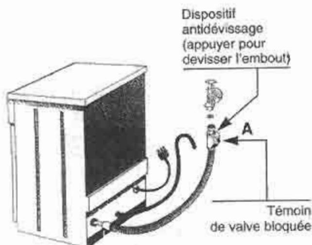
Le tuyau d'alimentation, doublé d'une gaine, est équipé d'un dispositif de blocage de l'eau. Dans le cas où le tuyau se détériorerait (usure naturelle ou surpression), l'eau s'écoulerait dans la gaine et actionnerait le dispositif de blocage de l'eau directement au robinet.
