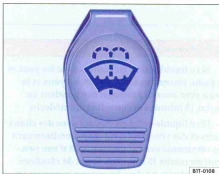
Fig. 82 Dans le compartiment-moteur : bouchon du réservoir de liquide de lave-glace.
