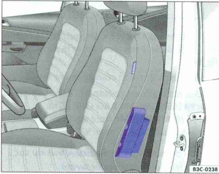
Fig. 65 Sur le côté du siège avant : emplacement de montage du sac gonflable latéral.
