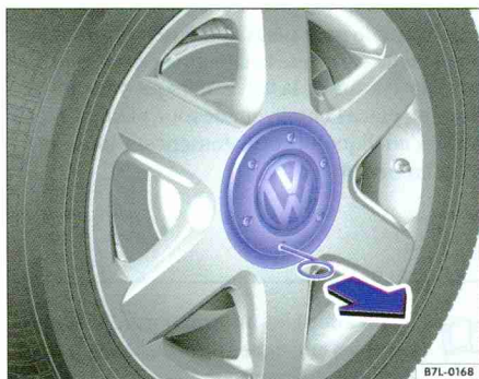
Fig. 187 Extraction de l'enjoliveur central en tirant
