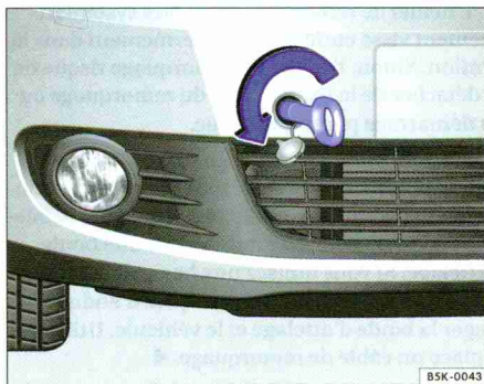
Fig. 212 Dans le pare-chocs avant, du côté droit : visage de l'oeillet de remorquage
