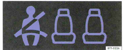
Fig. 47 Indicateur de statut des ceintures pour les places arrière dans le combiné d'instruments.
