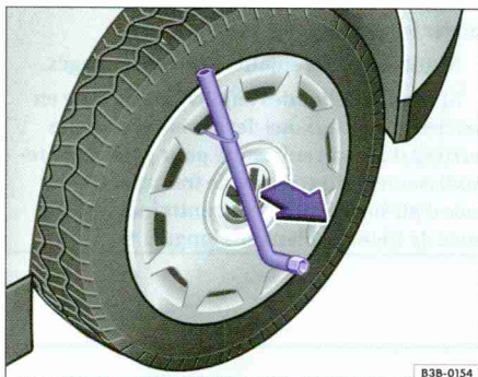
Fig. 189 Retrait de l'enjoliveur de roue plein
