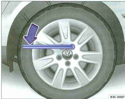
Fig. 191 Change ment d'une roue : desserrage des boulons de roue
