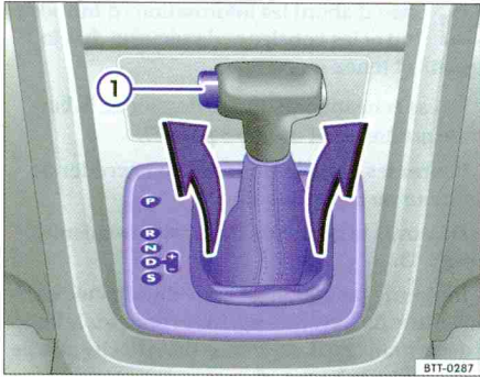
Fig. 183 Déposez le cache de la grille de guidage.
