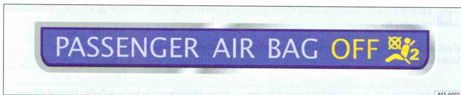
Fig. 58 Sur le tableau de bord, témoin du sac gonflable du passager avant désactivé.
