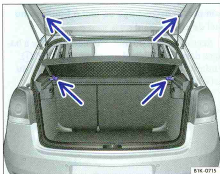
Fig. 90 Dans le coffre à bagages : dépose et repose du couvre-coffre.
