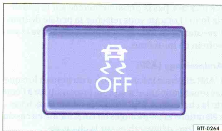
Fig. 129 Dans la console centrale : touche de désactivation et d'activation manuelles de la fonction ASR (véhicules avec ESP).
