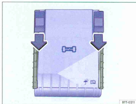
Fig. 198 Dans le compartiment-moteur : cache de boîte à fusibles
