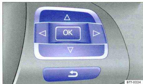
Fig. 11 Côté droit du volant multifonction : éléments de commande des menus sur le combiné d'instruments
