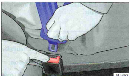
Fig. 54 Retrait du pêne du boîtier de verrouillage.
