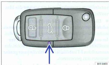
Fig. 16 Témoin de pile dans la clé à radiocommande.
