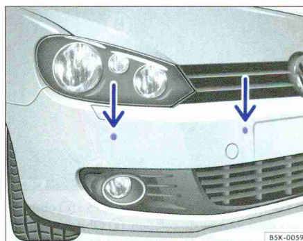
Fig. 135 Capteurs du système d'aide au stationnement avant du pare-chocs
