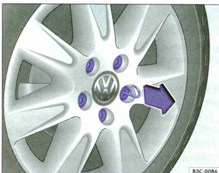
Fig. 190 Retrait des capuchons de boulons de roue
