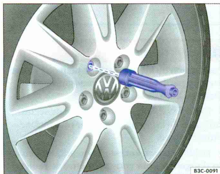
Fig. 195 Changement d'une roue : dévissage des boulons de roue à l'aide du manche de tournevis
