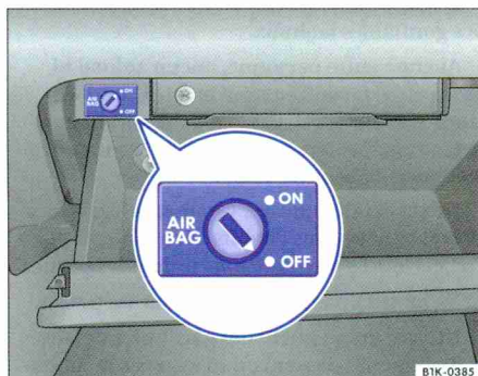
Fig. 64 Dans le rangement côté passager avant : commande à clé de désactivation et d'activation du sac gonflable frontal du passager avant.
