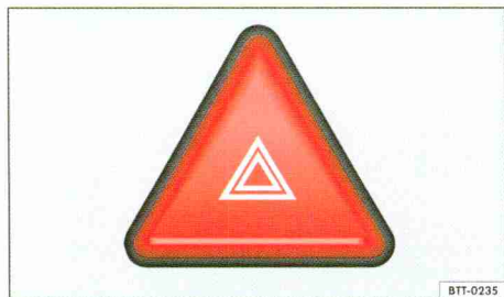
Fig. 175 Au centre du tableau de bord : commande du signal de détresse.
