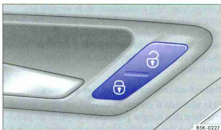
Fig. 19 Dans la porte du conducteur : touche de verrouillage centralisé.
