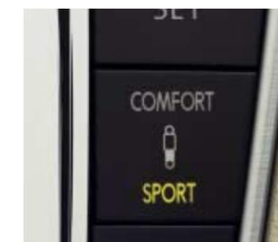
La nouvelle régulation pilotée de l'amortissement. Un simple bouton suffit pour choisir un style de conduite, normal, sportif ou confortable.
