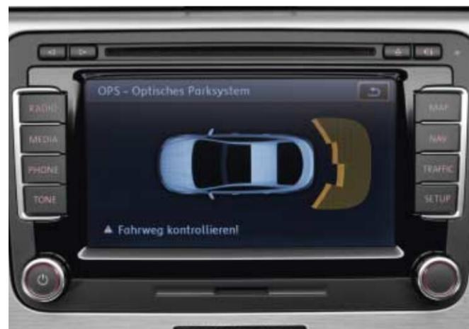
Sur les véhicules à la fois équipé de radars de stationnement et des radios RCD 310 / RCD 510 et navigation RNS 310 / RNS 510, l'écran permet de visualiser les obstacles.
