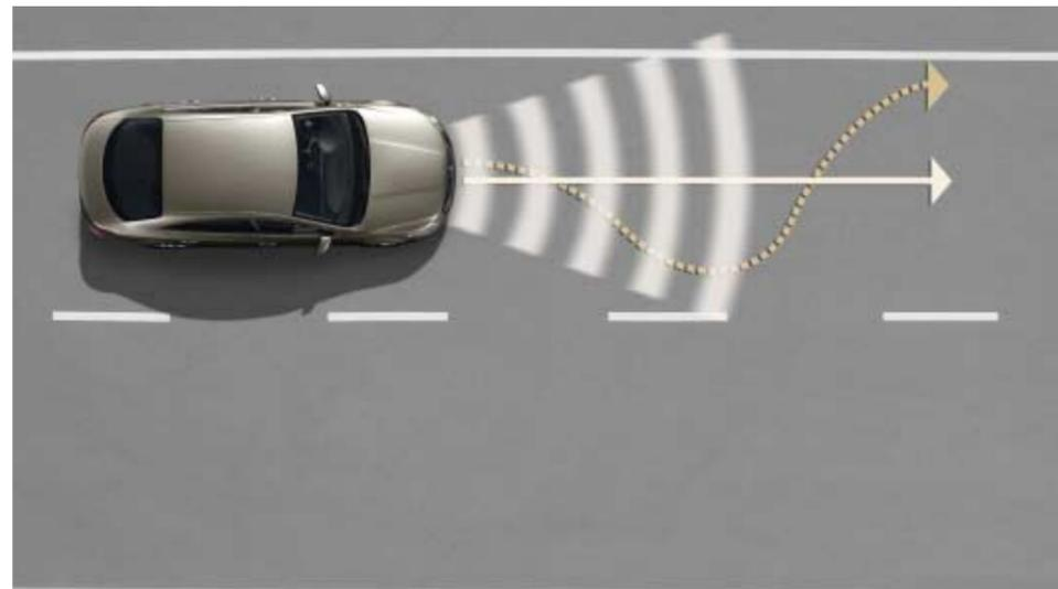
Alerte de franchissement de ligne "Lane Assist" : ce système intervient en cas d'écart involontaire de la part du conducteur. Il corrige alors la trajectoire du véhicule en agissant sur la direction. En option.
