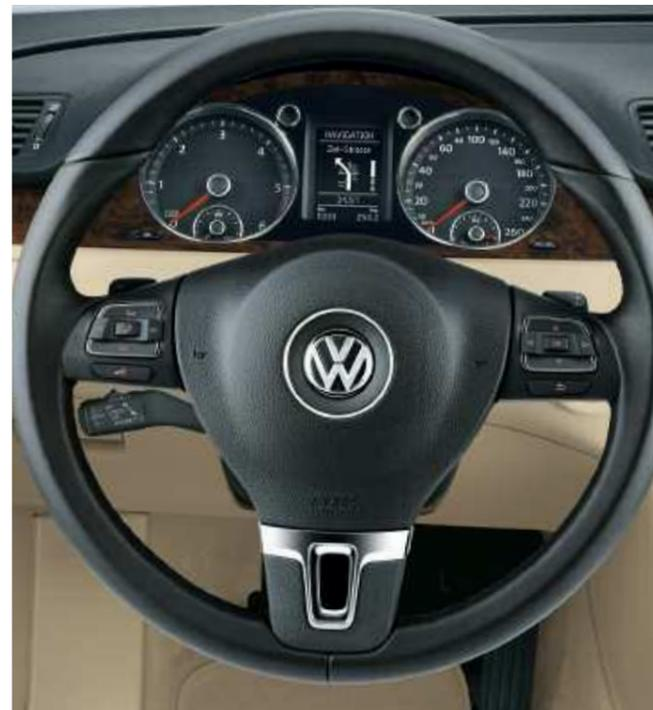
**Le volant multifonction de série sur Confortline, Carat, Carat Édition.** Il vous permet de commander confortablement la radio, le téléphone et l'indicateur multifonction de votre Passat, sans que vous ayez à quitter le volant des mains ni la route des yeux. Si vous optez pour une boîte automatique ou à double embrayage DSG, ce volant peut être équipé en option de palettes de changement de vitesses pour boîtes de vitesses DSG ou Tiptronic.
