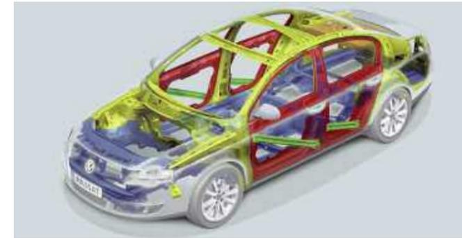
**La carrosserie.** La carrosserie de la Passat comporte des pièces spécifiques à la fois robustes et déformables. Grâce à son architecture moderne faisant appel à des matériaux légers, elle offre une excellente protection y compris en cas d'accident grave.
