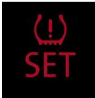
**Le contrôle de pression des pneus.** En cas de perte de pression de l'un des quatre pneus, le contrôle de pression en option vous prévient à l'aide d'un symbole sur l'indicateur multifonction. Vous savez ainsi en temps voulu qu'il est nécessaire de vérifier la pression des pneus. De série sur Carat et Carat Edition.
