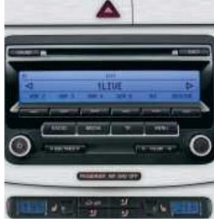
Le système radio "RCD 310 MP3" de série sur Carat. Sur ce système, la puissance de 4 x 20 watts est restituée par huit haut-parleurs.
