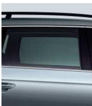
**Les vitres surteintées.** Des vitres arrière absorbant la lumière jusqu'à 65 % préservent les passagers arrière d'un ensoleillement trop intense et des regards indiscrets.
