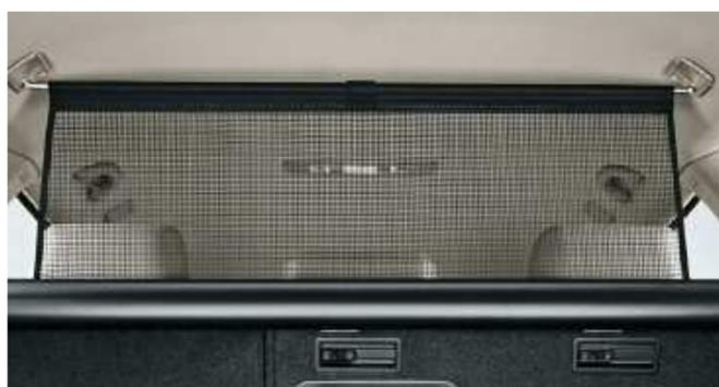
**Le filet de séparation (pour SW).** Ce filet extrêmement pratique se fixe entre la banquette arrière et le coffre. Il empêche le contenu du coffre d'être projeté dans l'habitacle en cas de freinage brutal.
