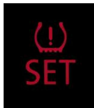
**L'indicateur de pression des pneus.** Cet indicateur sur le tableau de bord s'allume dès que la pression des pneus devient anormale. De série sur Carat et Carat Édition (Disponible dans le Pack City).
