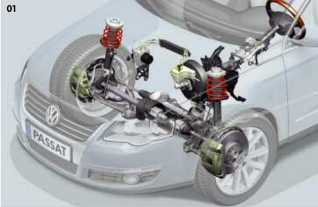
**01/02 L'essieu avant à jambes de force et l'essieu arrière à quatre bras.** Afin qu'un voyage en Passat soit à la fois sûr et confortable, son châssis est équipé d'un essieu avant à jambes de force et d'un essieu arrière à quatre bras. Cette architecture absorbe efficacement les inégalités de la route et assure une fidélité de trajectoire optimale.
