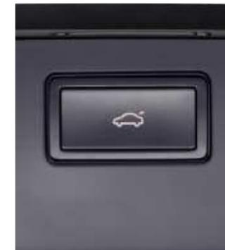
**L'ouverture et la fermeture motorisée du hayon de votre SW.** Permettant de choisir entre deux angles d'ouverture, elle facilite considérablement le chargement et le déchargement. Elle permet d'accéder plus aisément au coffre. Grâce à une butée programmable, le hayon ne risque plus de heurter la porte du garage. L'ouverture s'effectue à l'aide de la clé à radiofréquence ou d'une touche directement sur le hayon, la fermeture à l'aide de la touche sur le hayon.
