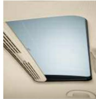
**Le toit ouvrant coulissant/entrebaillable en verre.** Il se commande à l'aide d'un bouton tournant sur le ciel de pavillon. Un sélecteur de position intégré permet de l'ouvrir ou de le relever exactement comme on désire. En cas d'obstacle, une protection antipincement électronique ultra sensible bloque immédiatement le processus. (Disponible également dans le Pack Vision optionnel).
