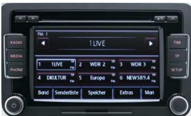
**Le système radio “RCD 510 MP3”.** Ce système radio à écran tactile 16:9 possède un chargeur 6 CD intégré en façade, un lecteur de carte SD, une connexion pour prise auxiliaire, le tout compatible MP3. Sa sonorité peut être restituée par huit haut-parleurs. Puissance de sortie : 4 x 20 watts. Une numérotation des appels est possible si l'option préparation est téléphone choisie. En option sur la gamme Passat sauf Carat Edition.
