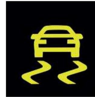
**Le correcteur électronique de trajectoire.** L'entrée en action du correcteur électronique de trajectoire vous est signalée par un témoin sur le tableau de bord. Un capteur d'angle de braquage compare en permanence la direction voulue au mouvement effectif du véhicule.
