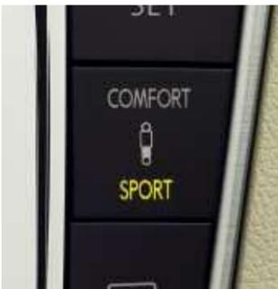
**La nouvelle régulation pilotée de l'amortissement.** Un simple bouton suffit pour choisir un style de conduite, normal, sportif ou confortable.
