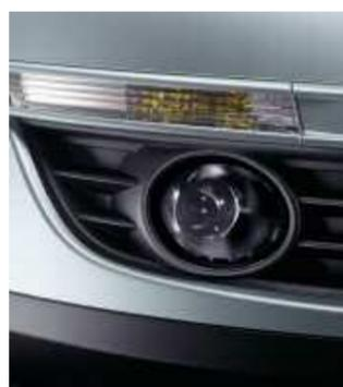
**Les phares antibrouillard.** Grâce à leur faisceau lumineux particulièrement intense, ils assurent une meilleure visibilité donc une plus grande sécurité, y compris en cas d'épais brouillard. En option sur Trendline.
