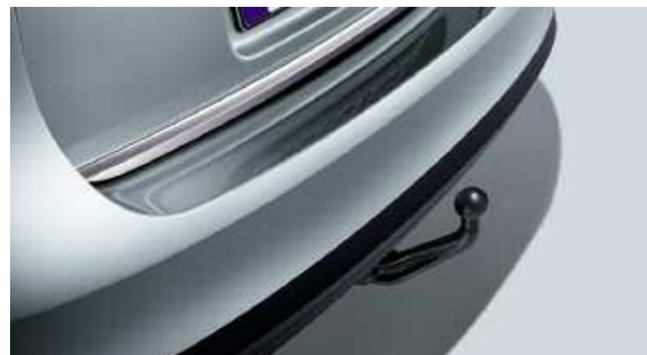
**Le crochet d'attelage amovible avec fonction Auto-Hold\* et stabilisation d'attelage.** Même avec un poids remorqué de 2,2 t maximum (selon la motorisation) vous conservez facilement votre cap grâce à la stabilisation d'attelage. Les capteurs de l'ESP détectent immédiatement toute velléité de perte de contrôle de la remorque et la stabilisent en agissant sur les freins de la Passat. \* La fonction Auto-Hold est expliquée page 39.
