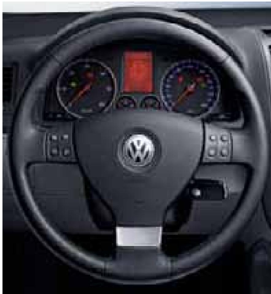
**Volant cuir multifonction** permettant de piloter l'autoradio ou le système de radionavigation et l'ordinateur de bord avec afficheur, cela sans lâcher le volant (de série sur Jetta Confortline).
