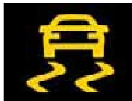
Le correcteur électronique de trajectoire (ESP), proposé de série à partir des versions 122 ch et plus, assure le maintien de la trajectoire sur tout type de revêtement, même en cas de freinage brusque.
