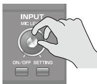
\* Il suffit généralement de régler le niveau d'entrée du micro une fois. Réglez le volume du "Vocal Designer" avec la commande VOLUME.
