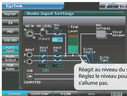
Réagit au niveau du signal d'entrée audio. Réglez le niveau pour que "PEAK" ne s'allume pas.
