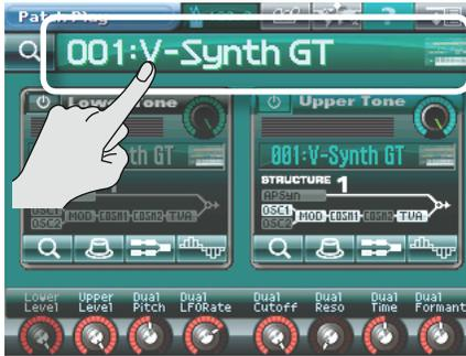
3. Sélectionnez un numéro de Patch avec la molette de réglage ou en appuyant sur le bouton [INC/+] ou [DEC/-].
