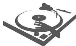
En faisant des mouvements circulaires avec le doigt sur le pad Time Trip, vous obtenez un effet de “scratching”.
