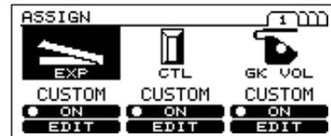
2. Appuyez sur [F2] (ON/OFF) pour activer/désactiver la fonction de contrôle de la pédale CTL.
