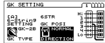
9. Tournez la molette VALUE pour indiquer la direction dans laquelle le capteur est installé.
