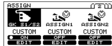
3. Appuyez sur [F1] (ON/OFF) pour activer/désactiver la fonction de contrôle du commutateur GK SW.
