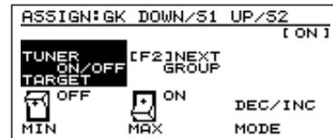
6. Appuyez sur [F1] (TARGET), puis tournez la molette VALUE pour sélectionner le paramètre à contrôler.
