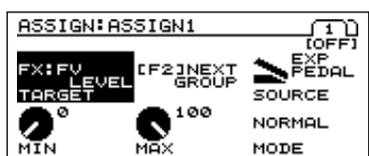
6. Appuyez sur [F1] (TARGET), puis tournez la molette VALUE pour sélectionner le paramètre à contrôler.
