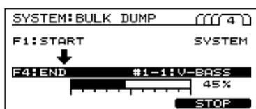
\* Pour interrompre la transmission, appuyez sur [F6] (STOP). Si vous appuyez sur [EXIT] pendant la transmission, celle-ci s'arrête et le système quitte la page de Bulk Dump.
