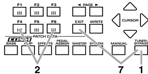
1. Appuyez sur [TUNER/BYPASS]. La fonction Tuner est activée.
