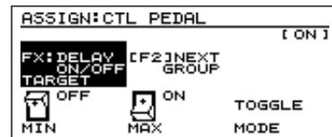
5. Appuyez sur [F1] (TARGET), puis utilisez la molette VALUE pour sélectionner le paramètre à contrôler.
