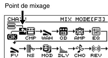
\* Appuyez sur [F3] (MIX MODE) si vous souhaitez intervertir le capteur et le micro normal.
