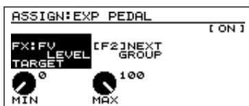
5. Appuyez sur [F1] (TARGET), puis utilisez la molette VALUE pour sélectionner le paramètre à contrôler.
