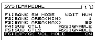
**ON :** La position courante des contrôleurs est prise en compte et appliquée sur le Patch chargé.
