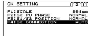
6. À l'aide de la molette VALUE, sélectionnez les conditions de connexion du V-Bass au capteur GK.
