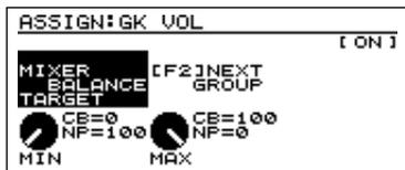
5. Appuyez sur [F1] (TARGET), puis tournez la molette VALUE pour sélectionner le paramètre à contrôler.
