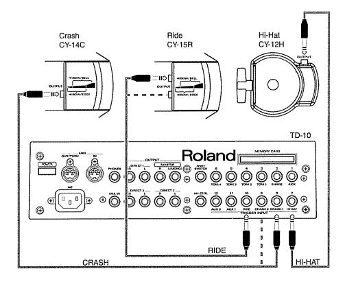
Utilisez les câbles de branchement fournis (stéréo) pour faire les connexions. Si des câbles mono sont utilisés, les frappes sur le bord, sur le dôme et le Choke ne seront pas possibles. La CY-14C n'a pas de sortie BOW/BELL. Faites le branchement sur la sortie BOW/EDGE.
