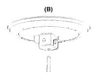
Il existe deux taçons de monter la tige du pied de batterie. Avant de changer sa position, serrez la vis, puis tourner l'écrou interne de 90 degrés.
