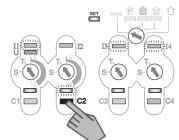
**4.** Appuyez maintenant sur la touche manuelle d'autres canaux (par ex. **C1** et **C3**). Les LED de sortie afférentes s'allument.
