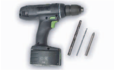
Perceuse avec mèche à bois DM 8mm, foret DM 3mm, croix
