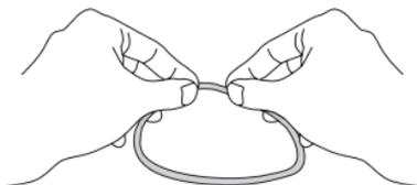
Retirer les matières étrangères collées à la rainure du joint en utilisant un chiffon propre. Retirer également le sable et la saleté collés sur la surface de contact du joint sur le couvercle avant du caisson.
