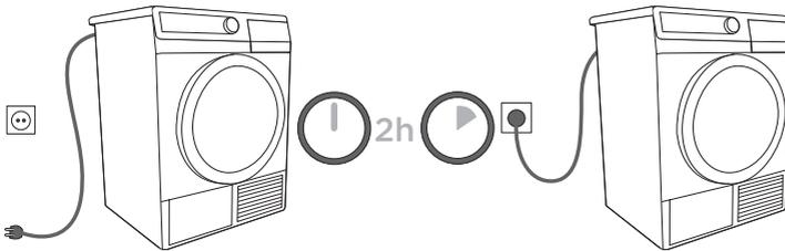
**Après avoir installé l'appareil dans son emplacement, attendez au moins deux heures avant de le brancher au réseau électrique afin de permettre au système de se stabiliser.**
