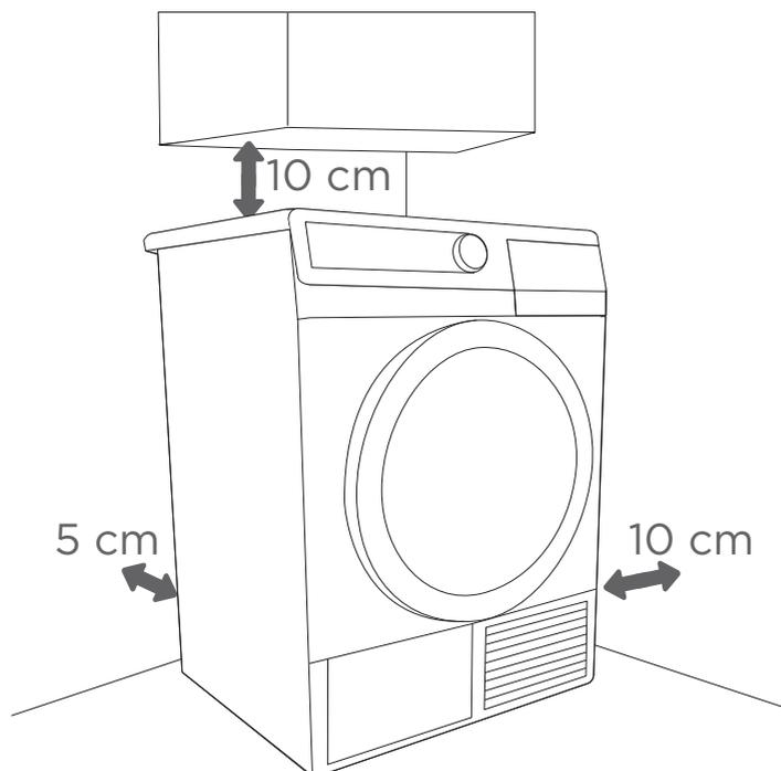
Les grilles d'aération en façade et à l'arrière du sèche-linge doivent toujours rester dégagées.
