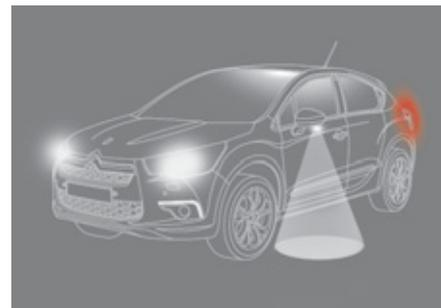
En cas de faible luminosité, détectée par un capteur, l'allumage à distance des feux de croisement et de position, ainsi que les spots latéraux, facilite votre approche du véhicule.
