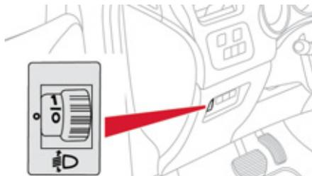
Pour ne pas gêner les autres usagers de la route, les projecteurs à lampes halogènes doivent être réglés en hauteur, en fonction de la charge du véhicule.
