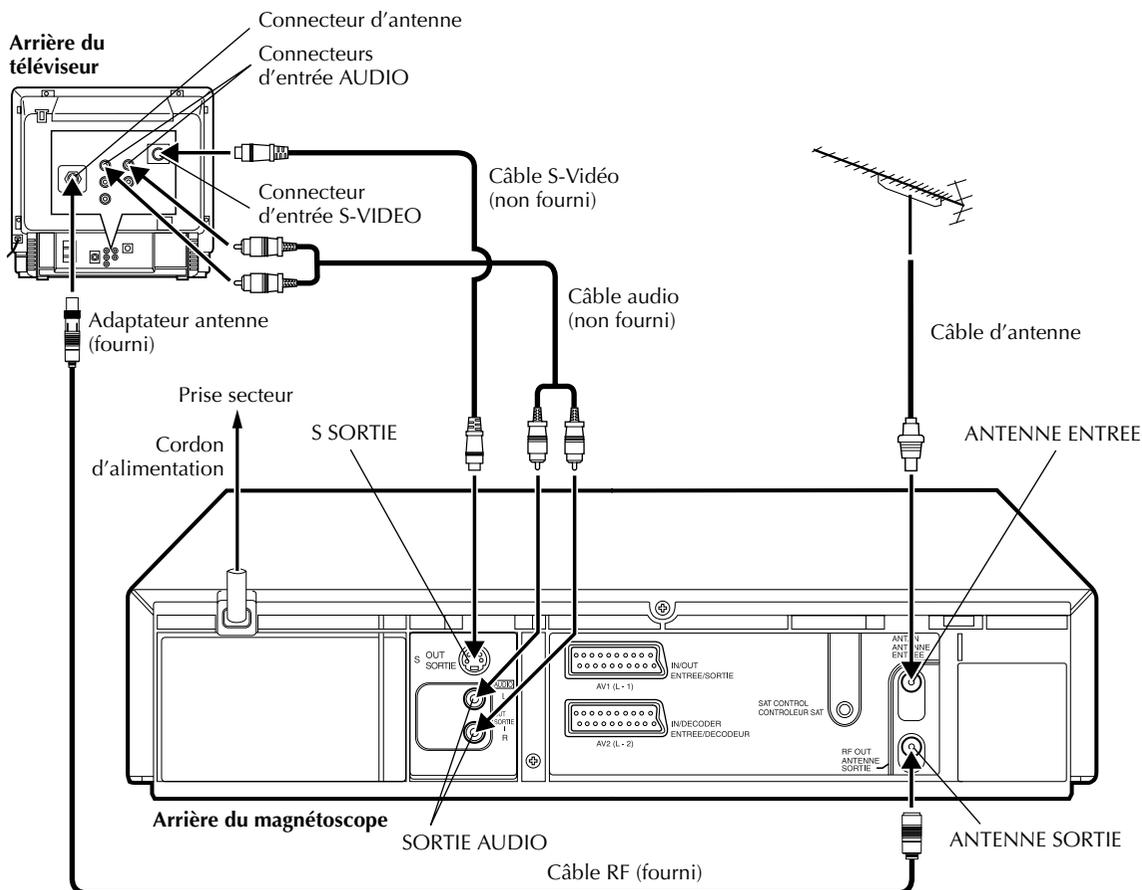
■ Pour raccorder un téléviseur avec connecteurs d'entrée S-VIDEO/AUDIO . . .
