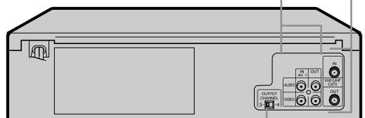
Sélecteur de canal de sortie 3 et 4 (reportez-vous à **Réglage du sélecteur des canaux de sortie 3 et 4**)
