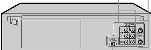
Sélecteur de canal de sortie 3 et 4 (reportez-vous à **Réglage du sélecteur des canaux de sortie 3 et 4**)
