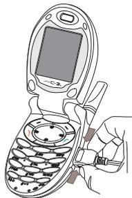
Votre téléphone est alimenté par une batterie rechargeable. Une batterie neuve doit être chargée pendant au moins 4 heures avant sa mise en service. Elle atteindra sa capacité optimale après quelques cycles d'utilisation. Lorsque votre batterie est déchargée, le téléphone l'affiche (icône batterie vide clignotante). Dans ce cas, rechargez votre batterie pendant au moins 15 minutes avant de passer une nouvelle communication afin d'éviter toute coupure.
