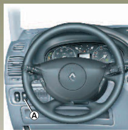
Le bouton **A** permet de corriger la hauteur des faisceaux en fonction de la charge.
