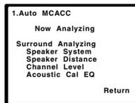
Un rapport de progression apparaît à l'écran pendant que le récepteur émet davantage de tonalités de test afin de déterminer les réglages optimum du récepteur en matière de niveau des canaux, distance des enceintes et calibrage Acoustic Calibration EQ.
