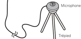
Si vous avez un trépied, utilisez-le pour y placer le microphone afin qu'il soit au niveau des oreilles à votre position d'écoute normale. Sinon, placez le microphone au niveau des oreilles en utilisant une table ou une chaise.
