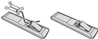
Les piles de la télécommande fournies avec l'appareil permettent d'effectuer les premières opérations : il est possible qu'elles ne durent pas très longtemps. Nous recommandons l'usage de piles alcalines, dont la durée de vie est supérieure.
