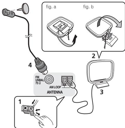
**1** Poussez sur les languettes pour les ouvrir, puis insérez complètement un fil dans chaque borne avant de relâcher les languettes pour mettre en place les fils de l'antenne AM.
