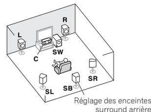
L'ajout d'une enceinte surround arrière (SB) à la configuration [A] étend l'effet surround à l'arrière. Lors de la connexion d'un caisson de basse avec cette configuration, veuillez à utiliser un modèle avec amplificateur intégré.
