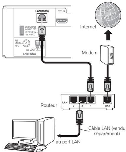
Raccordez la borne LAN de ce récepteur à la borne LAN de votre routeur (avec ou sans fonction de serveur DHCP) par un câble LAN direct (CAT 5 ou supérieur).
