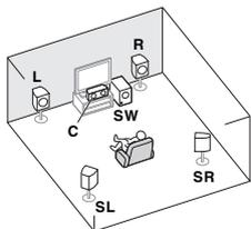
Un système surround de type 5.1 peut être obtenu en connectant les enceintes avant gauche et droite (L/R), l'enceinte centrale (C), les enceintes surround gauche et droite (SL/SR), et le caisson de basse (SW).
