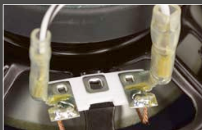
L'installation d'un haut-parleur universel nécessite de couper le câble pour qu'il s'adapte exactement au haut-parleur.
