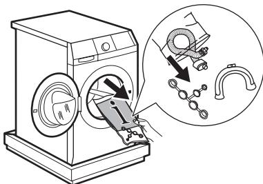
6. Placez l'une des cales en polystyrène au sol derrière l'appareil. Couchez avec soin l'appareil sur le dos. Assurez-vous de ne pas endommager les tuyaux.
