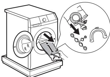
6. Appoggiare sul pavimento, dietro l'apparecchiatura, uno degli elementi di imballaggio in polistirolo. Sistemare il lato posteriore dell'apparecchiatura sul polistirolo, facendo attenzione. Assicurarsi di non danneggiare i tubi.
