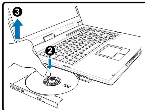
1. Lorsque le portable est allumé, pressez le bouton d'éjection du lecteur de disque. Le tiroir s'éjecte partiellement.
