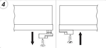
Retirez les caches (A) et (B), dévissez les vis et retirez partiellement le panneau en faisant attention à ne pas endommager les pièces électriques qui se trouvent derrière.
