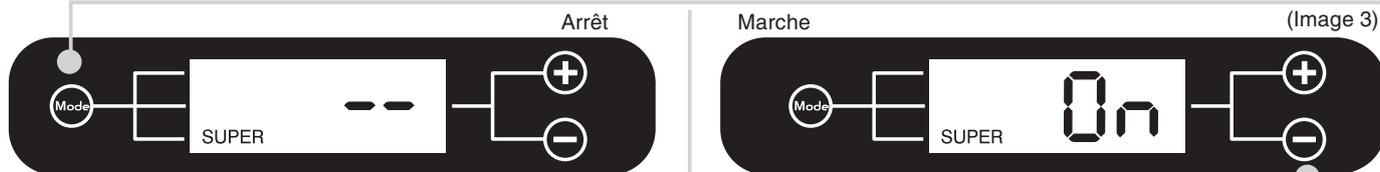
Appareils ELECTRONIQUES sans technologie NO FROST : Appuyez sur la touche (+) afin d'activer la fonction SUPER. Placez les aliments à congeler dans le compartiment congélateur. A la fin du temps pré-réglé, l'appareil quitte automatiquement la fonction SUPER. Si vous souhaitez interrompre la fonction SUPER, vous pouvez à tout moment appuyer sur la touche (-).
