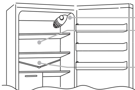
Le thermostat commandant l'appareil se trouve en haut à droite l'intérieur du réfrigérateur. Pour vérifier que l'appareil fonctionne, assurez-vous que le bouton du thermostat ne se trouve pas en position "0". Réglez le bouton selon la température désirée dans le réfrigérateur.
