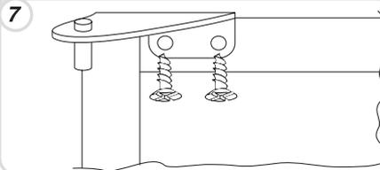
Installez le panneau et fixez-le à l'aide des vis et des caches.
