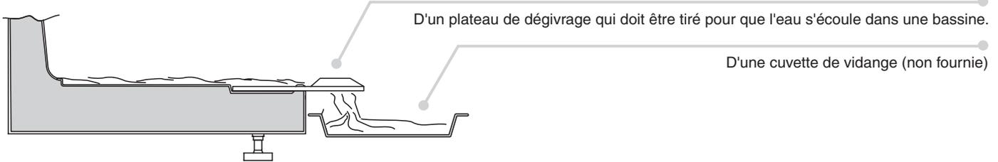
Pour les réfrigérateurs avec la technologie NO FROST, le système de drainage de l'eau est automatique pendant le dégivrage.
