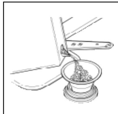
Le lave-vaisselle est pourvu d'un adoucisseur qui purifie l'eau du calcaire pouvant incruster et endommager le lave-vaisselle.
