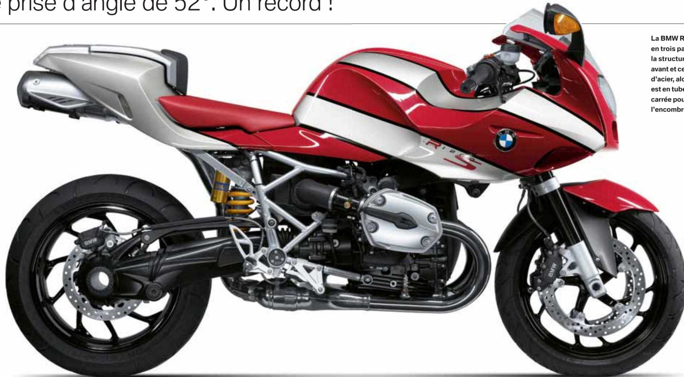
La BMW R 1200 S possède un cadre en trois parties avec moteur intégré à la structure portante. Les éléments avant et central du treillis sont en tubes d'acier, alors que l'élément arrière vissé est en tubes d'aluminium léger à section carrée pour optimiser le poids et limiter l'encombrement.
