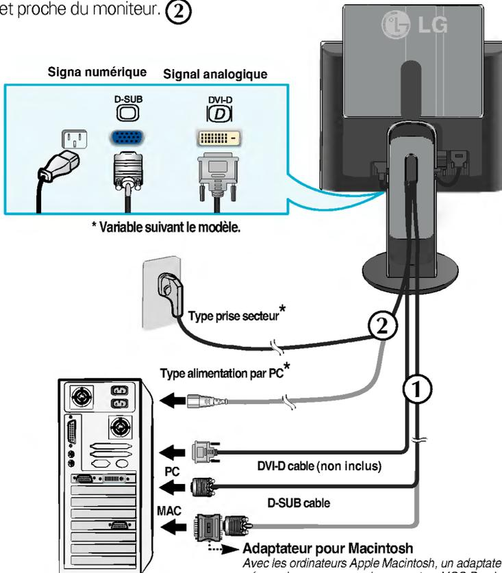
Avec les ordinateurs Apple Macintosh, un adaptateur est nécessaire pour passer du connecteur VGS D-sub haute densité à 15 broches sur 3 rangées du câble fourni au connecteur à 15 broches sur 2 rangées.
