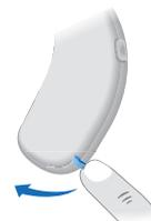
Insérez la pile ou l'accumulateur dans le tiroir pile de façon à ce que les symboles de polarités + coïncident avec la marque + sur le tiroir pile.
