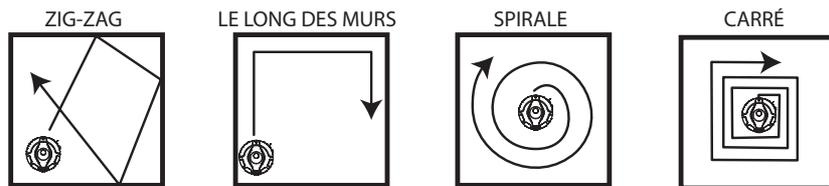
Appuyez sur la touche tactile SPOT sur le robot ou sur le bouton SPOT de la télécommande pour activer le mode de nettoyage SPOT. Utilisez ce mode pour concentrer le nettoyage sur une zone précise. Robo.com<sup>2</sup> se déplacera en suivant un mouvement en spirale dont le rayon augmentera continuellement pendant environ 1 minute 30.
