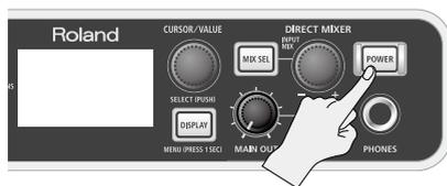
Cet appareil est doté d'un circuit de protection. Il faut attendre un bref laps de temps (quelques secondes) après la mise sous tension pour que l'appareil fonctionne normalement.
