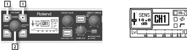
1. Utilisez les boutons CHANNEL [ ] [ ] pour sélectionner le canal à régler.
