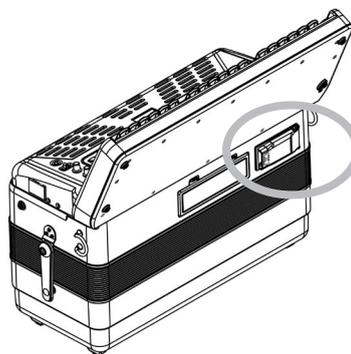
3. Appuyez sur les deux côtés du couvercle du compartiment USB (sur les mentions "PRESS TO OPEN") et ouvrez le couvercle.
