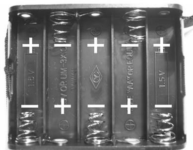
6. Insérez le boîtier contenant les 10 piles (5 + 5) dans le compartiment.
