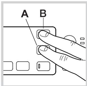
Pour activer le programme, appuyer simultanément sur les touches **A** et **B** pendant 5 secondes (voir figure). Le programme démarrera automatiquement et durera environ 70
