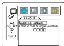
● Vous pouvez sélectionner d'autres langues pour **SON**, **SOUS-TITRE** et **MENU DU DISQUE** seulement si cette langue est offerte sur le disque. Si la langue que vous avez sélectionnée n'est pas enregistrée sur le DVD, la modification de ces paramètres n'aura aucun effet.
