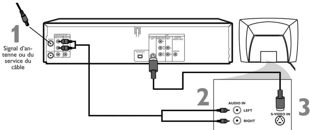
**1** Raccordez le signal d'antenne ou du service du câble à la prise **ANT-IN** de votre lecteur DVD/magnétoscope.
