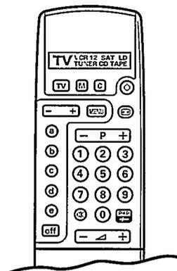
Sur l'afficheur de la télécommande, les lettres **TV** doivent apparaître sur un fond gris.
