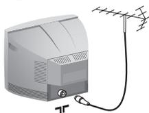
Csatlakoztassa a TV antennadugóját a készülék hátoldalán található
