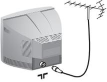
Introduzca el conector de antena de televisión en la toma
