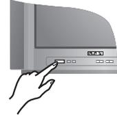
Para encender el televisor, pulse la tecla de encendido / apagado. Si el televisor queda en espera, pulse la tecla **P**
