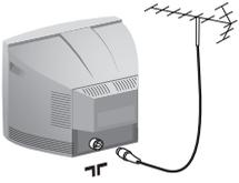
Stop de stekker van de tv-antenne in de
