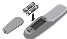
Вставьте в пульт дистанционного управления 2 батарейки типа R6, которые поставляются вместе с телевизором. Батарейки должны были установлены с правильной полярностью.
