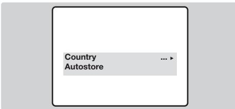
Wenn das Menü nicht angezeigt wird, halten Sie die Tasten  $\triangleleft$ - und  $\triangleleft+$  des Fernsehgeräts 5 Sekunden lang gedrückt, um das Menü aufzurufen.
