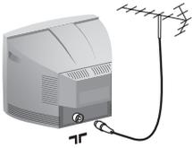
Podłącz wtyczkę antenową do gniazda TV z tyłu odbiornika.
