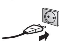
Tilslut netstikket til en stikkontakt (220-240 V / 50 Hz)
