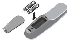
Inserire le due pile di tipo R6 (fornite) facendo attenzione alla polarità.
