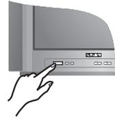
For å slå på TV-apparatet trykker du på på/av-knappen. Hvis apparatet er i standby, trykker du på tasten **P**
