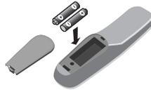
Sett inn de to 2 R6-batteriene på riktig måte (overhold polariteten).
