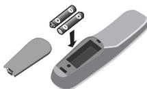
Vložte 2 baterie typu R6, které jsou přiloženy, a respektujte přítom jejich polaritu.
