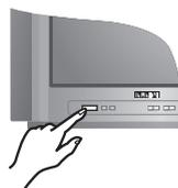
Zapnite televízor stlačením tlačidla pre zapínanie a vypínanie televízora. Ak je televízor v pohotovostnom režime, stlačte tlačidlo **P**
