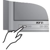
W celu włączenia odbiornika naciśnij przycisk włącz / wyłącz. Jeśli odbiornik pozostaje w stanie czuwania, naciśnij przycisk P (+) pilota.
