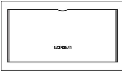
Votre appareil est équipé d'un filtre à charbon situé derrière un volet dans la paroi arrière du compartiment réfrigérateur. Le filtre purifie l'air en le débarrassant des odeurs indésirables présentes dans le réfrigérateur et dans le compartiment NATURAFRESH 0°C, ce qui améliore la qualité de la conservation des aliments.
