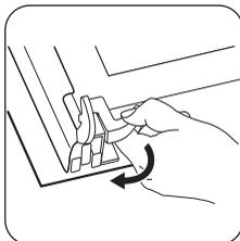
**5** Débloquez le système de verrouillage afin de retirer les panneaux de verre.
