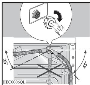
3. Pour ajuster l'orientation du raccord du tuyau d'alimentation, dévissez la bague de serrage placée à l'arrière de l'appareil. Après avoir positionné le tuyau d'alimentation, veillez à visser correctement la bague de serrage pour éviter toute fuite.
