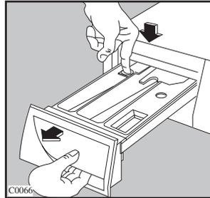
Pour faciliter le nettoyage, la partie supérieure du compartiment réservé à l'additif doit être enlevée.
