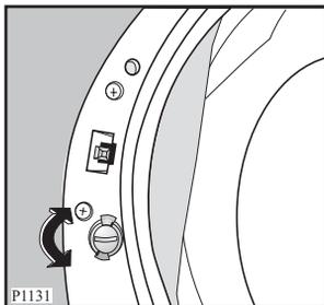
Pour désactiver ce dispositif et permettre la fermeture du hublot, tournez le bouton dans le sens inverse des aiguilles d'une montre jusqu'à ce que la rainure soit verticale.
