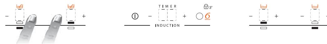
Pour modifier le niveau de puissance (de 1 à 9 max. ou P), appuyez sur les touches -/+ . Pour désactiver la fonction Flexi cook, appuyez simultanément sur les 2 touches de sélection des foyers. Pour éteindre instantanément les deux foyers, maintenez l'une des touches de sélection des foyers enfoncée pendant 3 secondes.
