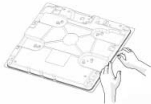
Installez la table de cuisson dans l'ouverture du plan de cuisson dont les dimensions doivent correspondre à celles figurant dans la fiche produit.
