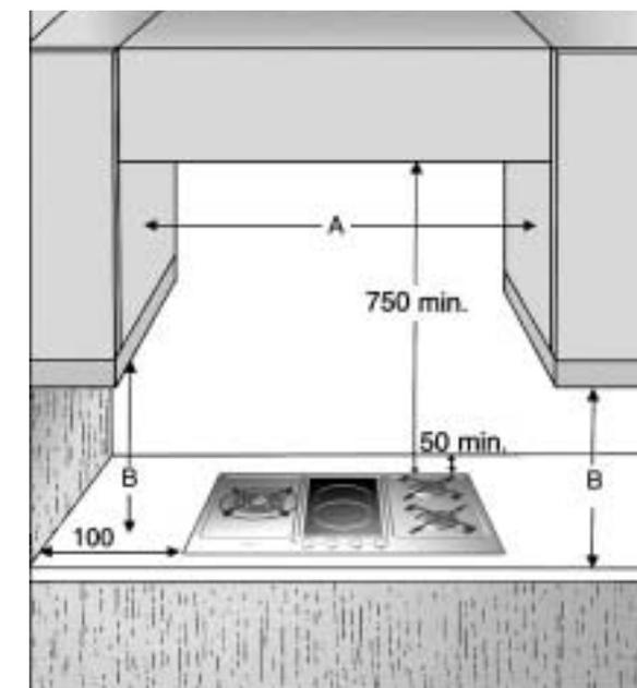
**REMARQUE :** Si la distance "A" entre les éléments muraux se situe entre 600 mm et 730 mm, la hauteur "B" doit être d'au moins 530 mm. Si la distance "A" entre les éléments muraux est supérieure à la largeur de la table de cuisson, la hauteur "B" doit être d'au moins 400 mm. Avant d'installer une hotte au-dessus du plan de cuisson, veuillez vous référer au manuel d'utilisation de la hotte dans lequel sont spécifiées les distances appropriées.
