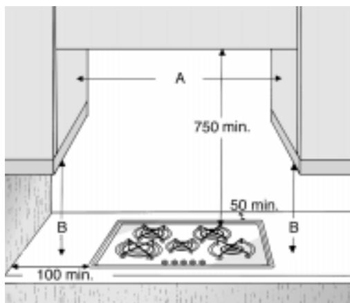
**REMARQUE :** si la distance "A" entre les éléments muraux est de 600 mm à 680 mm, la hauteur "B" doit être au minimum de 520 mm.
